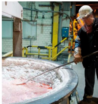
Bild 7: Abdecksalz über einer Aluminiumschmelze Foto: Tagesschau
