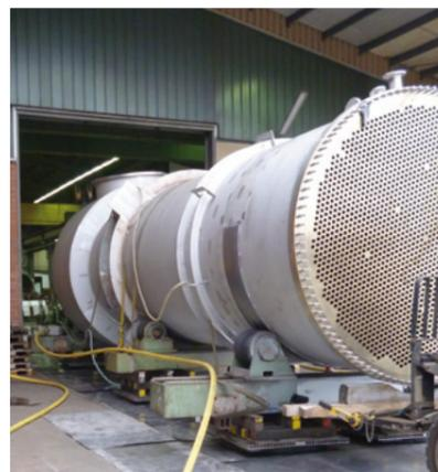
Bild 9: Wärmetauscher fertig zusammengebaut auf dem Werkshof der Fa. Ebner
