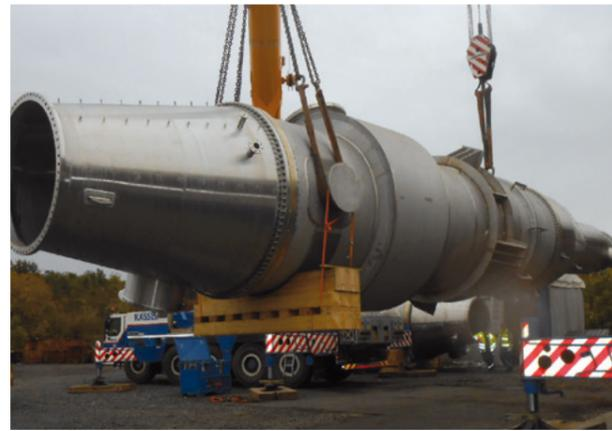
Bild 7: Rohrbündelwärmetauscher auf dem Werksgelände der Fertigungsfirma Ebner in Eiterfeld
