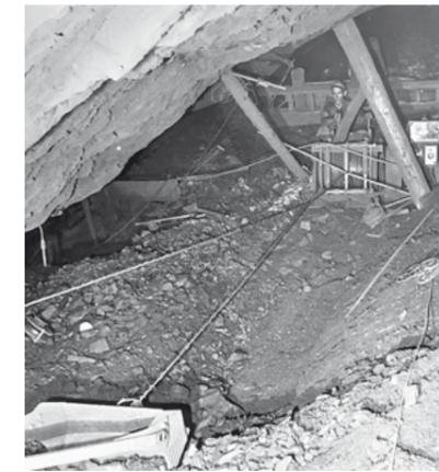
Bild 3: Grube Königszug, Abbauförderung mit Schrapper
