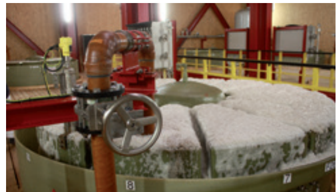
Pneumatische Flotationszelle. Der entstandene Konzentrat-Schaum wird filtriert und zusammen mit dem abgetrennten Kainit als Feuchtsalz zur Herstellung von Kaliumsulfat der Sulfatfabrik zugeführt.
