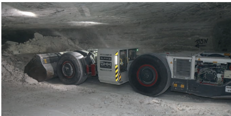
Abb. 2: Mit speziellen Ladetransportfahrzeugen („Ladern“) wird das herausgesprengte Rohsalz aufgenommen und zu den Kippstellen transportiert, wo es zerkleinert und weiter transportiert wird
