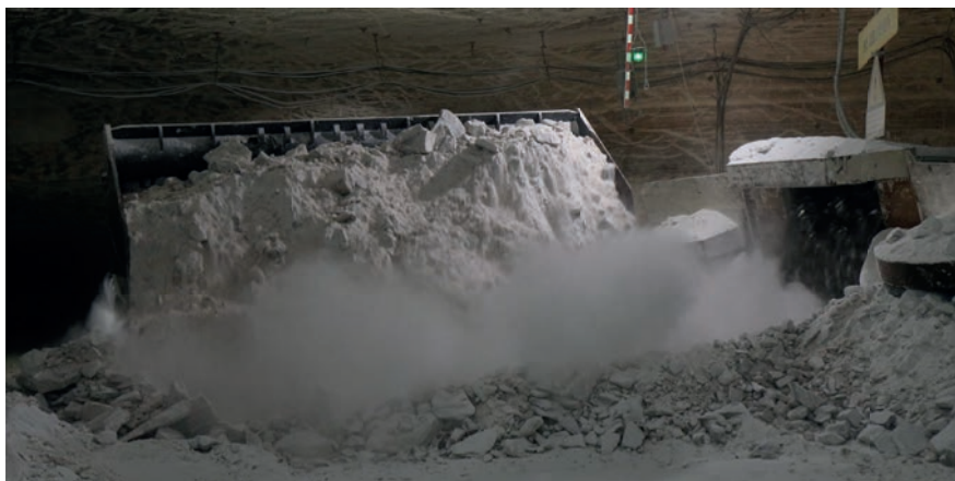
Abb. 3: An der Kippstelle. Dort leeren die Ladetransportfahrzeuge („Lader“) ihren Schaufelinhalt. Ein Brecher zerkleinert das herausgesprengte Rohsalz und befördert es über die angeschlossenen Transportbänder zu den Schächten
