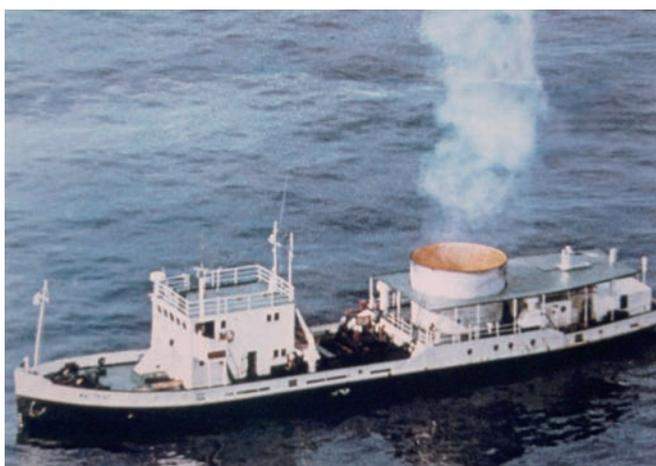
Abb. 2: Verbrennungsschiff für Sonderabfälle
