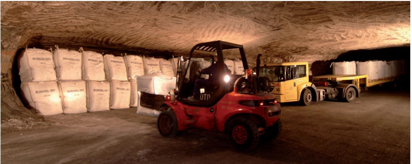
Abb. 18: Einlagerung von big bags mit Filterstäuben
