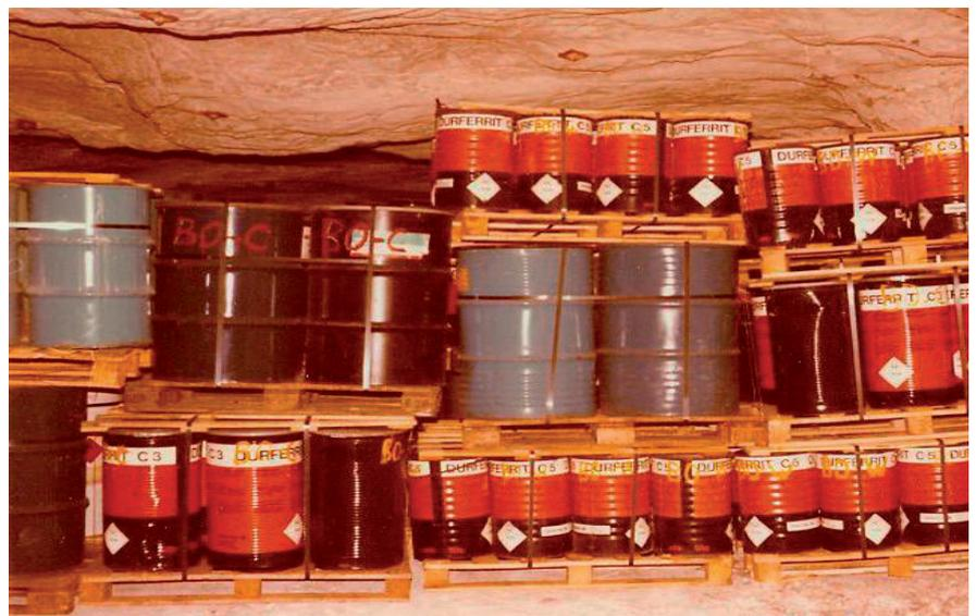
Abb. 8: Ablagerungsraum mit Cyanid-haltigen Härtesalzrückständen
