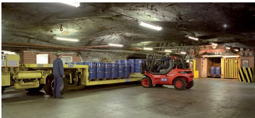
Abb. 14: Abfallverladung auf Tieflader im Füllort Schacht Herfa
