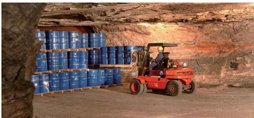
Abb. 16: Einstapeln der Abfallfässer im Einlagerungsraum
