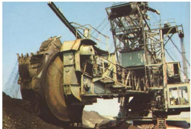
Bild 4: Schaukelradbagger im Wetterauer Braunkohlentagebau
