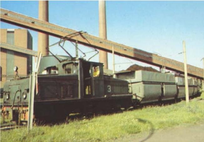
Bild 5: Elektrische Grubenbahn zum Abraum-, Kohle- und Aschetransport
